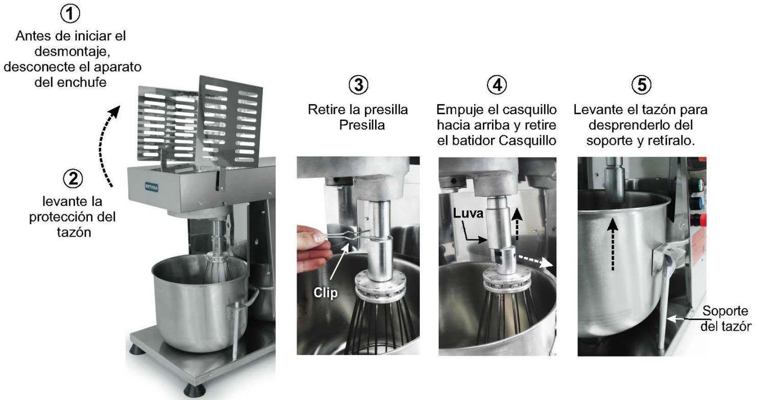
• **Montaje:** El procedimiento de montaje es realizado en sentido inverso del desmontaje. Cuando se monta el mezclador, debe escogerse el modelo que se adecua a su necesidad en aquel momento. Debe fijarse todas las piezas perfectamente para que no ocurra el trabado o desgaste y dar una garantía de seguridad al operador.
